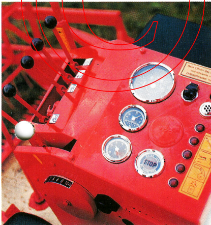
3 Armaturentafel und Bedienungshebel für Hydraulik
