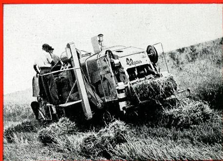
**Vanskelige forhold** - intet problem for CLAAS COLUMBUS! Særligt ved mejning af lejesæd under ugunstige terrænforhold viser den sin overlegenhed på grund af det med kraftige spiralfjedre aibalanceerede skæreapparat, som af sig selv følger jordens ujevnheder. Skæreapparat og lejesædsvinde bliver ved mejning af lejesæd virksomt understøttet af indføringstromlen og kædeellevatoren i sluget. Således er det muligt uden spild at høste fuldstændig nedstromlet, ukrudtsfyldt og gennemvokset lejesæd.
