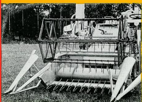
Det affjedrede skæapparat med aks-hævere (CLAAS-patent) og lejesædsvinden med styrede fjedertænder kan uafhængigt af hinanden indstilles hydraulisk i højden. Lange fremadstillede delere (CLAAS-patent) skiller stråene og sørger for en ren skárkant.
